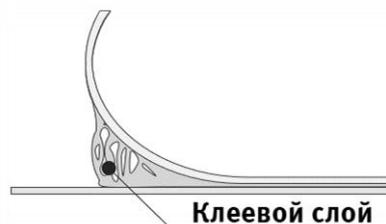
**Защитный слой (Подложка)** – препятствует взаимодействию клеевого слоя с любой поверхностью, в том числе склеиванию полотна в одном рулоне.
