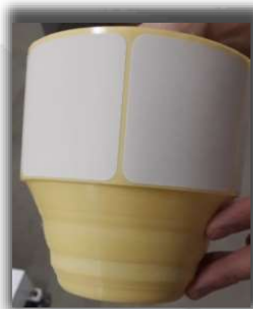
Рисунок 8. Пример некачественного выполненного ролика по натяжению с телескопированием материала
